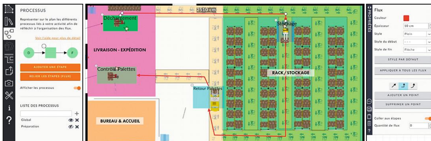
Figure 6: Processus (étapes D à F, bloc de gauche): définition d'un flux (fenêtre spécifique, bloc de droite)
